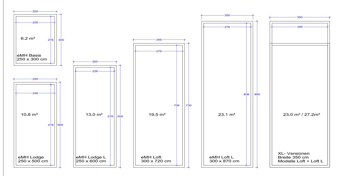
Die Masse beziehen sich auf die Holz100 Wände von Thoma. Je nach Bedarf an Aussendämmung verändern sich die Aussenmasse des eMH Die Innenmasse bleiben unverändert, sofern bei den Holz100 Wänden keine zustätzlichen Wandpaneele aus Lehm, Verputz o.ä, aufgebaut werden.
